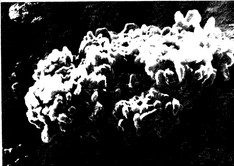
N- Pyrite ( \text{FeS}_2 ), puits #6 x 5,000, échelle: 5 \mu\text{M}
