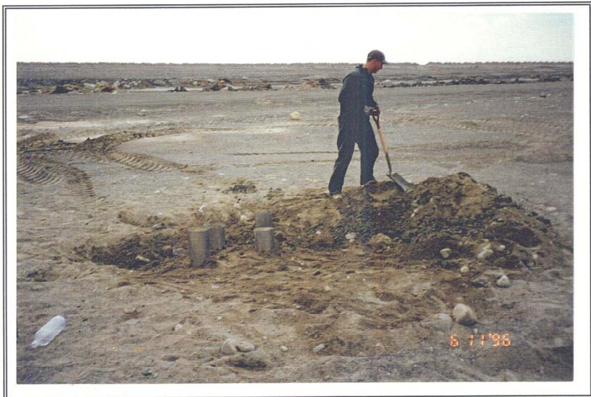
PHOTOGRAPHIE 39: Station de mesure de consommation d'oxygène.
