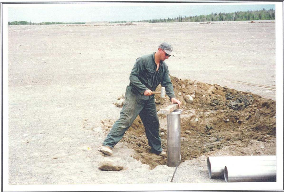
PHOTOGRAPHIE 38: Mise en place d'une station de mesure de consommation d'oxygène.
