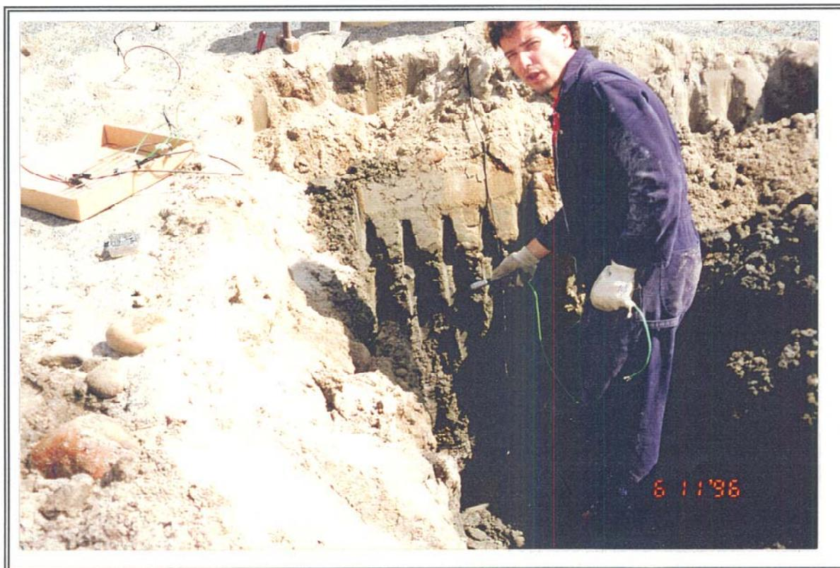
PHOTOGRAPHIE 41: Mise en place d'une sonde Watermark.
