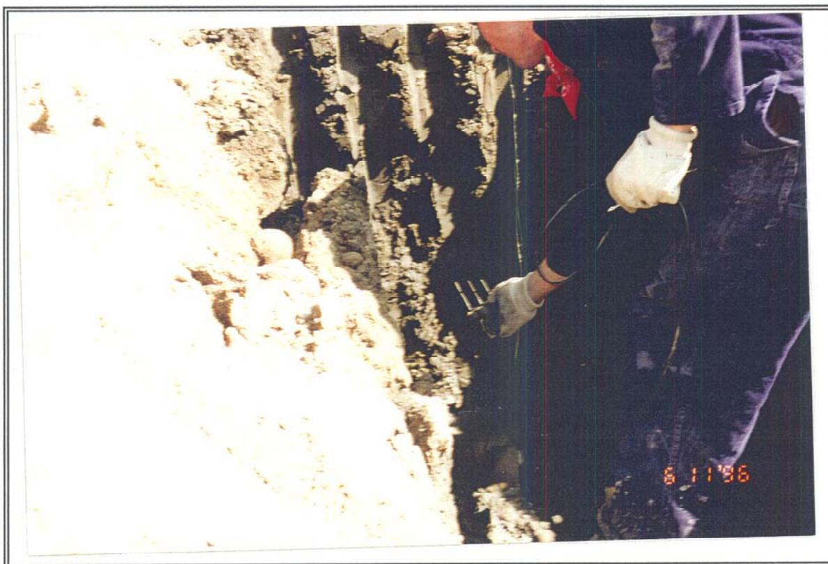
PHOTOGRAPHIE 40: Mise en place d'une sonde TDR.
